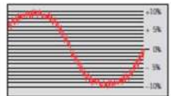
Spannungsstabilität und Spannungsverlauf herkömmliche Technik.
